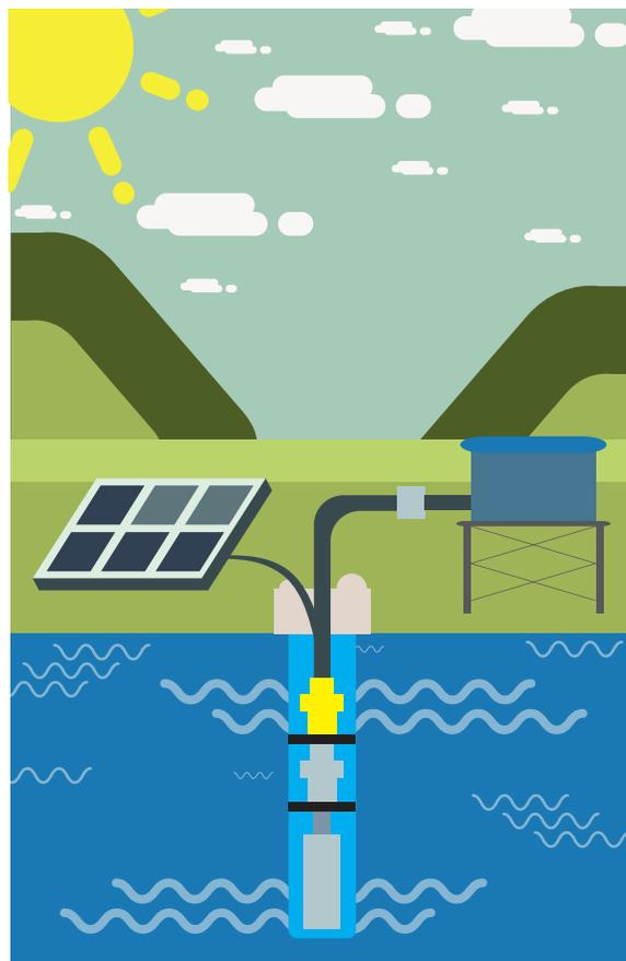
El Kit bombeo solar es una de los aplicativos energeticos que no requiere de sistemas de alimentación de red eléctrica. Los sistemas de riego, agua potable y, en general, para el bombeo de agua funcionan con autonomía.
